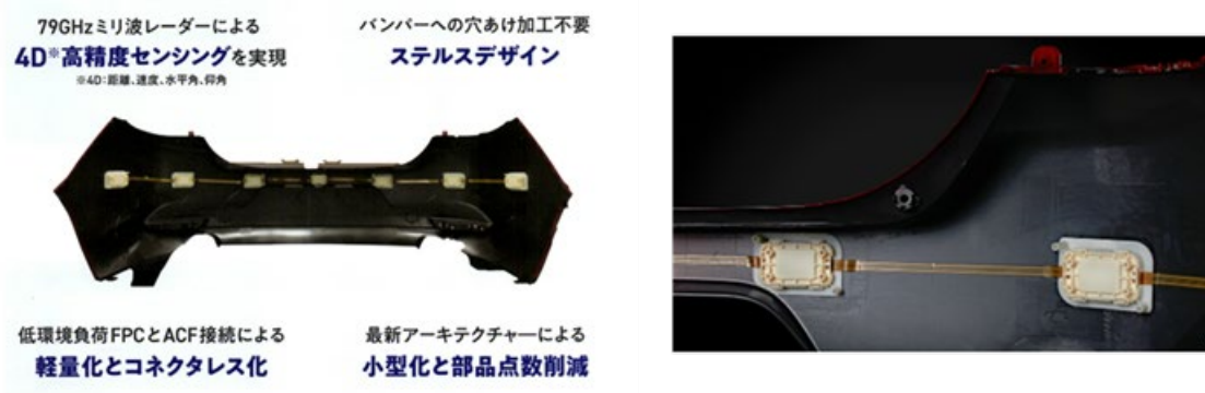
写真2：弊社 P-Flex® を採用頂いたバンパーミリ波レーダーコンセプト
