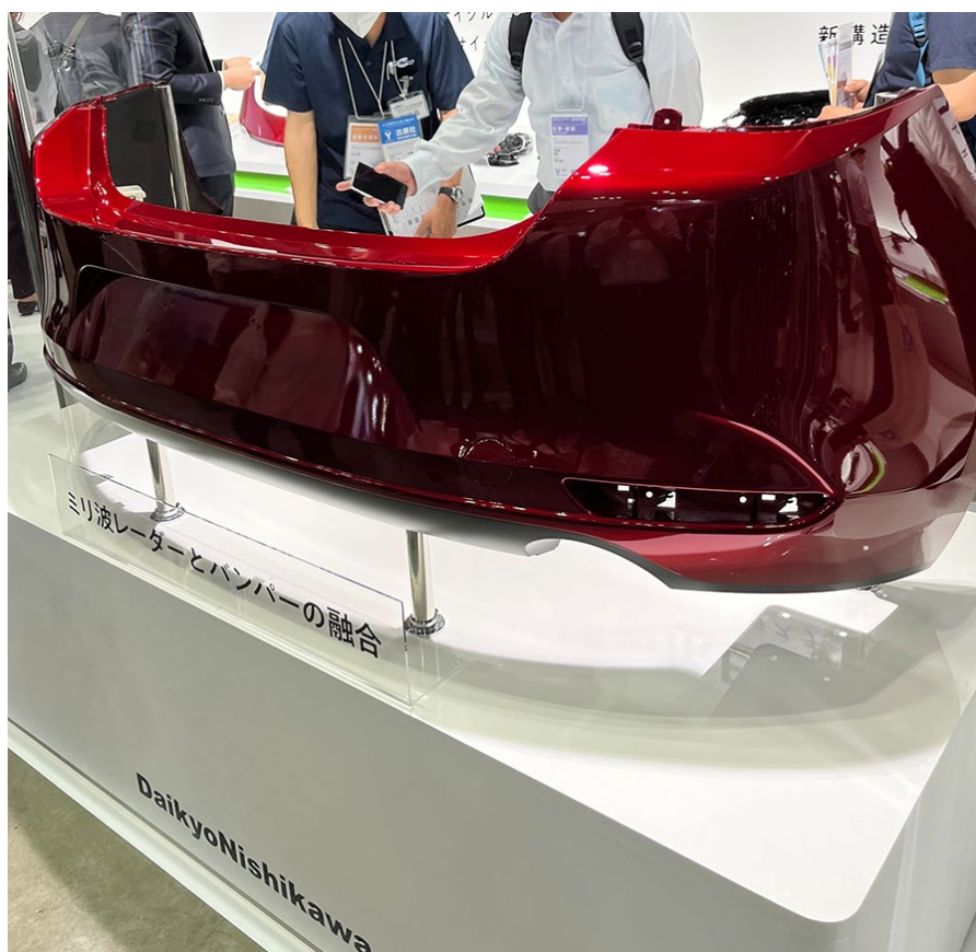
写真1：弊社 P-Flex®を採用頂いたバンパーミリ波レーダーコンセプト
