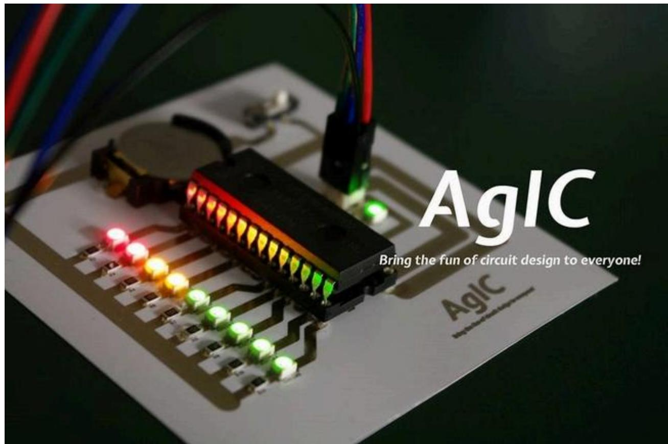
3Dプリンター等の登場によって、新しいアイデアや製品を簡単に試作できるようになりました。いわゆる Makerムーブメントと呼ばれる動きが加速しています。このモノ作り革命をさらに一歩前進させる技術が、AgICの電子回路基板の簡単作成技術です。これまで、専門のプリント基板の製造業者に依頼していたような電子回路を、家庭用のプリンターを用いて簡単に自分で作成することができます。これにより、製品のプロトタイプの開発期間が飛躍的に短縮され、低コストで開発できます。
