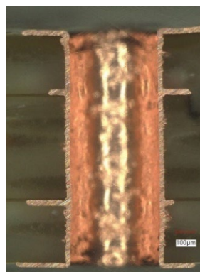
4 層基板の断面
